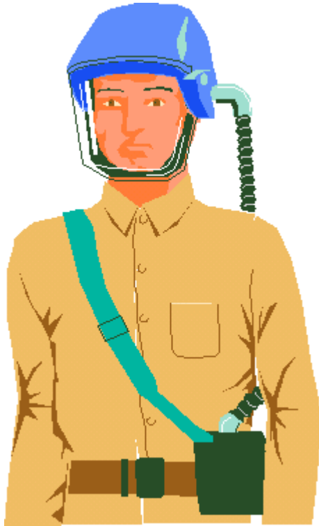
圖 6 使用頭盔式寬鬆面體的動力淨氣式呼吸防護具，繫掛於佩戴者腰部的元件包括電池、送風機與淨氣裝置（湯大同繪）
