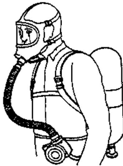
圖 9 使用自攜呼吸器工作的人員 (3M, 1987)
