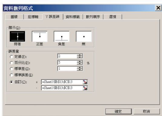
圖四、Excel「資料數列格式」中之「Y誤差線」索引標籤的方塊選項(圖中「顯示」區域選擇兩者，並在「誤差量」區域內點選自訂後指定自訂值所在之範圍位址)。
