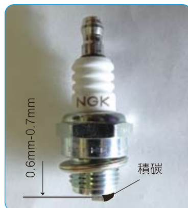
圖6. 火星塞間隙
