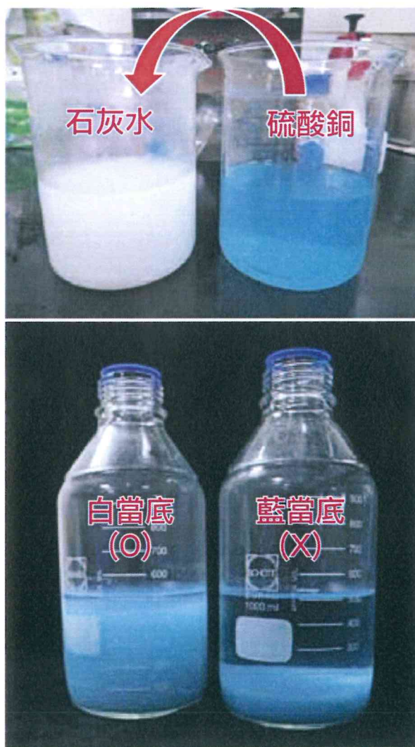
圖三、白(石灰水)當底，藍(硫酸銅)緩慢加入。產生的混合液顆粒細、具良好懸浮性(左)，若弄反者，產生的顆粒大，很快就沉澱(右)。
