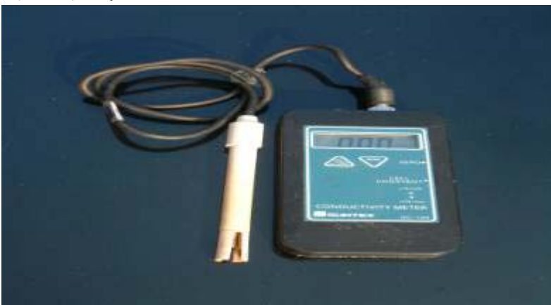
圖一電導度計(ECmete)，右圖為電導度計之電級區及左圖為白金桿和溫度感應桿
