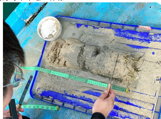
底土每 10cm 的厚度用樣本袋進行分裝並標示深度
