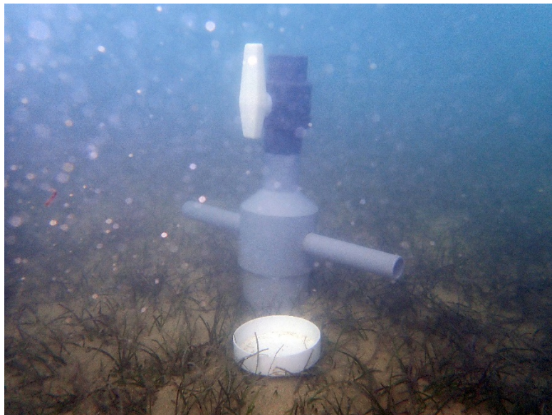
圖 12. 使用自製的 PVC 管採泥器進行海草床底土採樣
