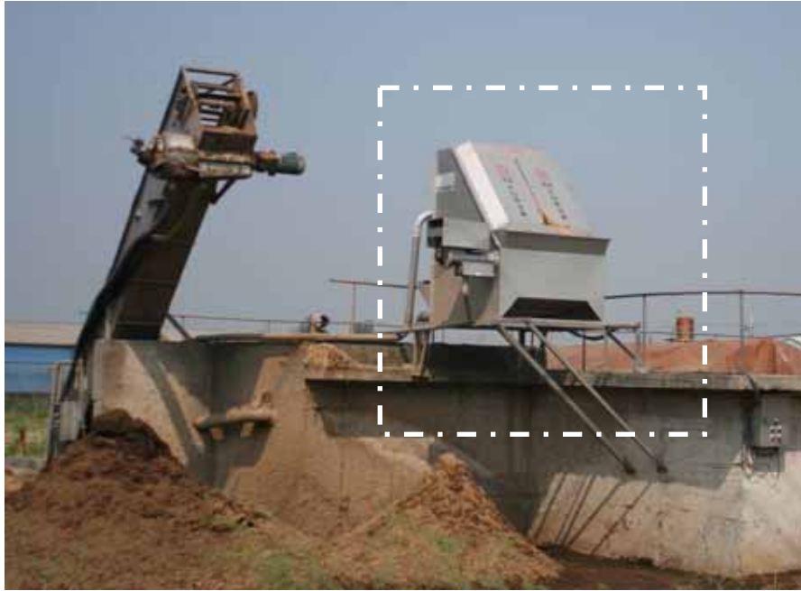
圖 1. 煉盛 LK-120P 型逕流式固液分離機。
