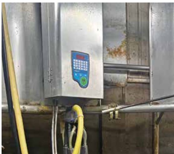
▲圖三、擠乳設備設有流量計，可以馬上得知牛隻的乳量情形。
