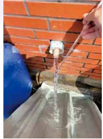
▲確認清洗水量及酸鹼PH值。 ▲量測出水溫度。
