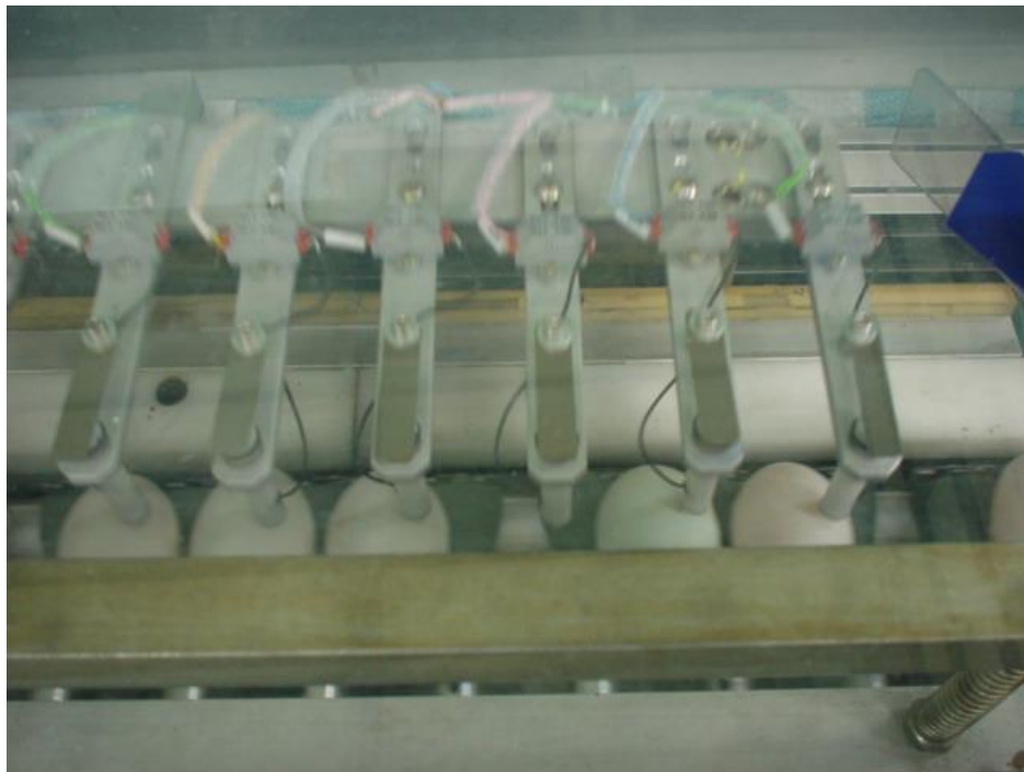
蛋殼裂痕檢測機：可檢測新鮮鴨蛋之蛋殼是否破裂。
