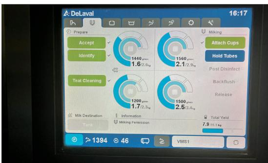
▲圖 5. 自動擠乳機器人控制面板，每個圓餅圖代表每個乳房擠乳量及出乳速率。
