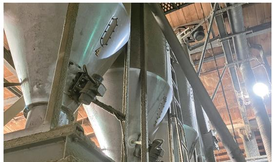
▲圖 10. 自動配料餵飼機器人 - 微量營養素放置桶。
