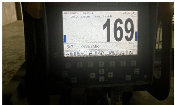
▲圖 8. 自動配料餵飼機器人 - 配料時採倒數計量模式。
