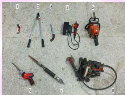
圖2. 果園常見修剪工具 1. 剪定鋏 2. 大型修枝剪 3. 手鋸 4. 電動修枝剪 5. 鏈鋸 6. 往復式電動鋸 7. 往復式氣動鋸 8. 引擎式修枝圓鋸
