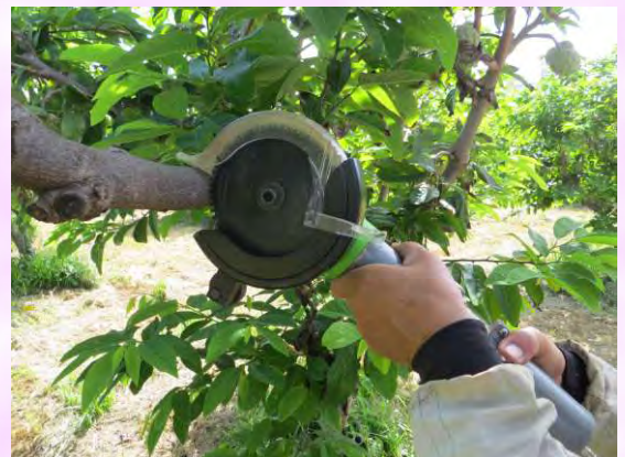
圖11. 雙向電動修枝鋸利用枝條推開活動保護罩即可進行切割
