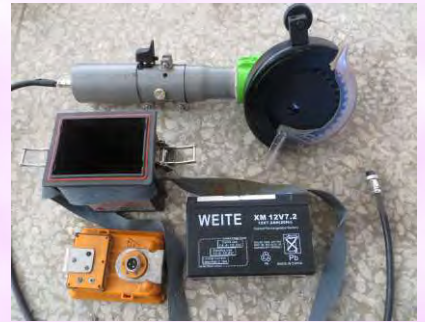
圖9. 雙向電動修枝鋸組成
