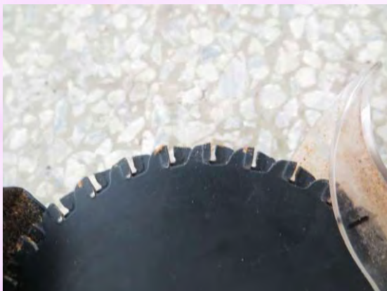
圖10. 兩片鋸片以不同方向旋轉可在鋸切動作模擬剪切
