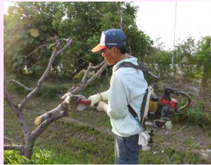
圖8.引擎式修枝鋸需要背附引擎，容易造成疲勞
