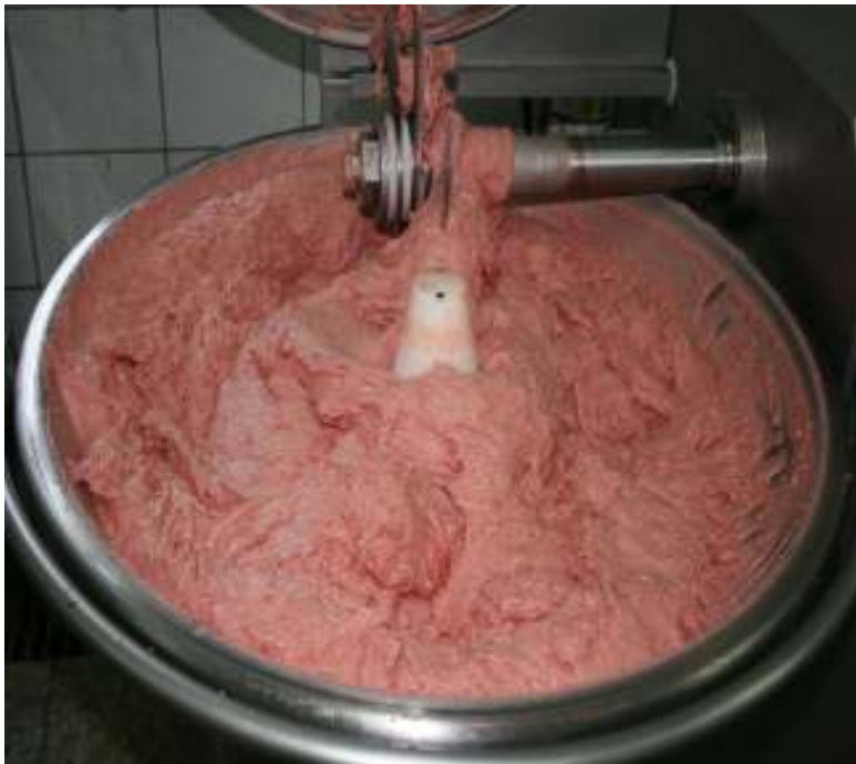
圖 1：使用乳化細切機細切原料肉後加入調味料混合。
