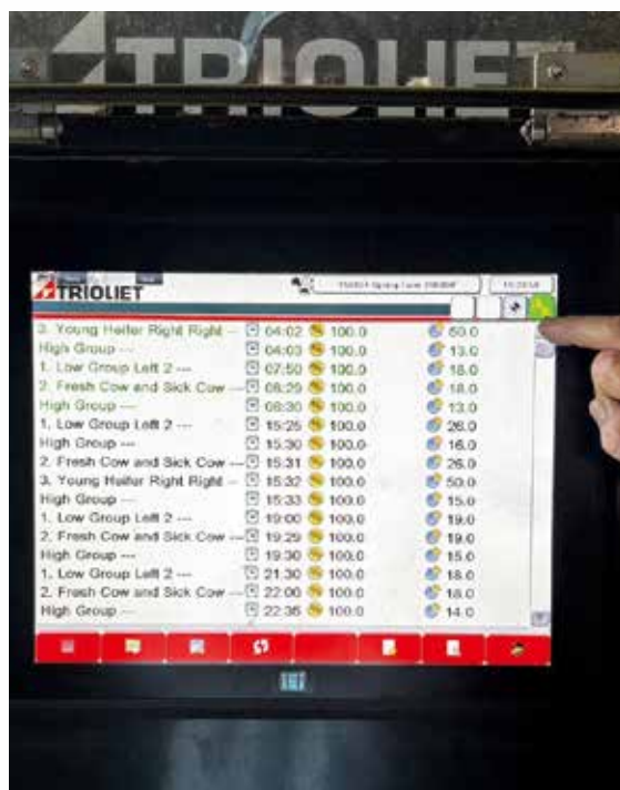
▲圖六、自動給飼機器人的操作介面。圖中可見分區餵飼的時間及次數。
