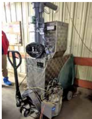
▲ 圖 3. 美國農業部乳牛芻料研究中心試驗乳牛場使用之 GreenFeed® 系統。
