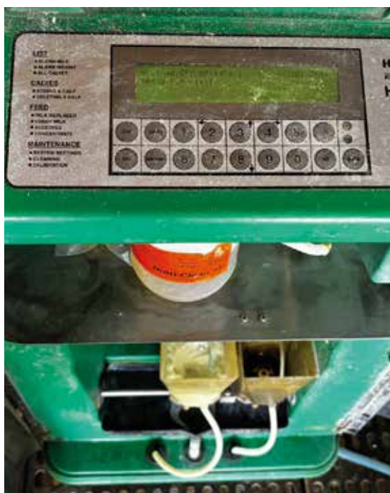
▲圖五、自動仔牛餵飼系統，下方為代乳粉沖泡進行中。
