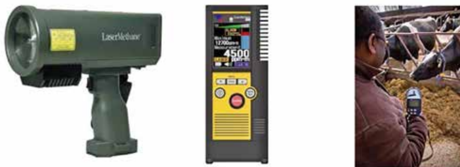
▲圖 5. 手持式雷射甲烷偵測器 ( Jonker and Waghorn, 2020 )。
