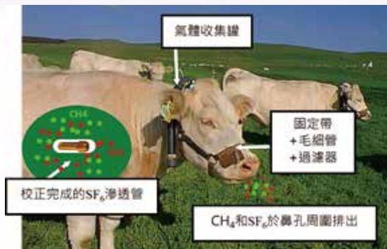
▲ 圖 2. SF 6 示蹤氣法簡介 (Rochette et al. , 2020)。
