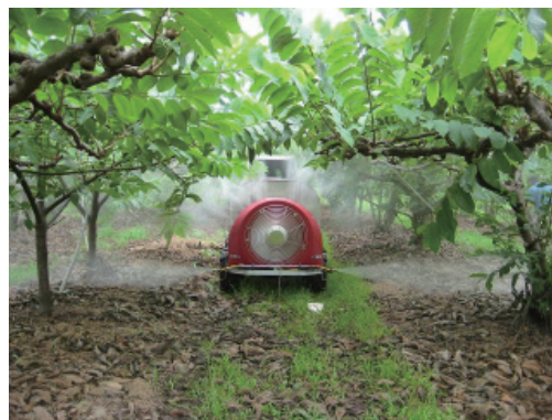
圖 6. 自走式噴霧車附掛雙噴頭噴桿減少施藥死角，提升病蟲害防治效果。
