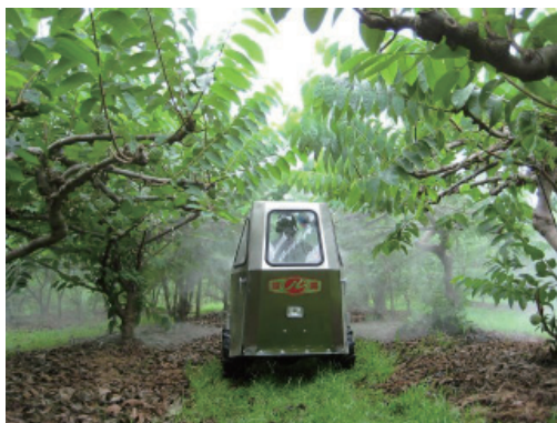
圖 5. 自走式噴霧車附掛雙噴頭噴桿施藥樹幹底部情形。
