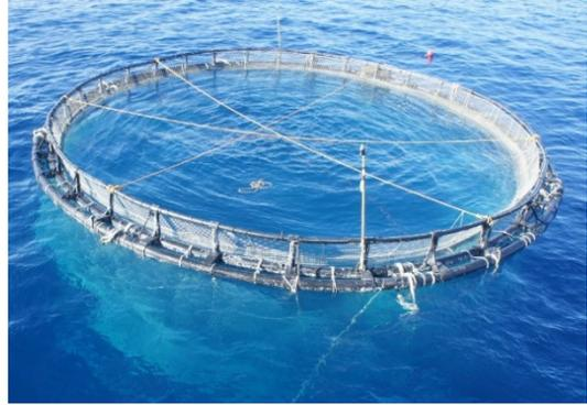
圖 2 放養黃鰭鮪採用的直徑 20 m、深 10 m 圓框式箱網
