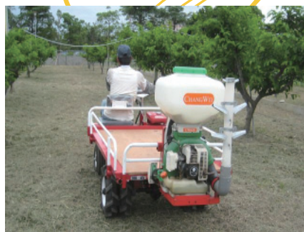
圖 15. 螞蟻餌劑撒布機果園作業情形。圖 16. 餌劑撒布組件可附掛在乘坐式割草機上進行作業。圖 17. 搬運車附掛餌劑撒布裝置進行餌劑撒布作業。
