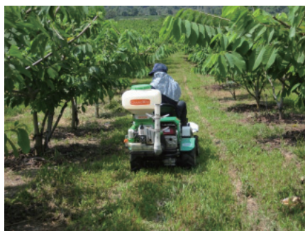
圖 15. 螞蟻餌劑撒布機果園作業情形。圖 16. 餌劑撒布組件可附掛在乘坐式割草機上進行作業。圖 17. 搬運車附掛餌劑撒布裝置進行餌劑撒布作業。
