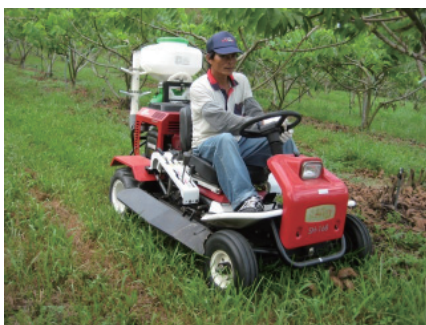
圖 15. 螞蟻餌劑撒布機果園作業情形。圖 16. 餌劑撒布組件可附掛在乘坐式割草機上進行作業。圖 17. 搬運車附掛餌劑撒布裝置進行餌劑撒布作業。
