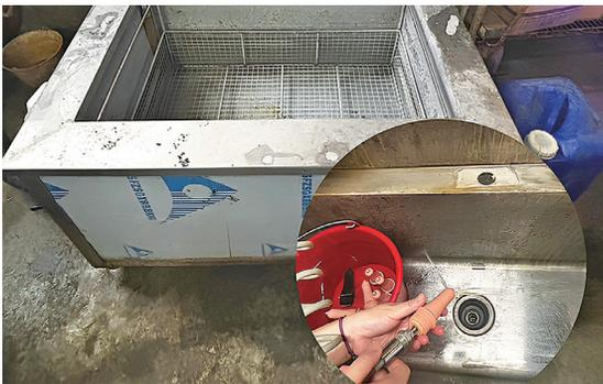
▲圖 2. 清洗小牛桶的超音波設備及使用尖端出水頭清潔乳嘴。
