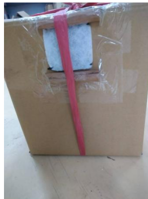
圖3. 運輸箱外進氣口(風扇)
