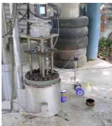
圖 1. 熱化學轉換器裝置微調式安全洩壓閥。
