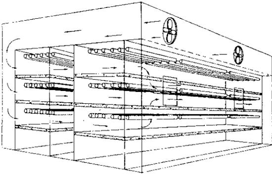
在台灣以6坪地房間，以3噸冷氣機（附加熱設施，以便冬天加溫），可把夏天的室溫冷卻到23°~25°C，冬天若寒流來襲，加溫至23°C。
