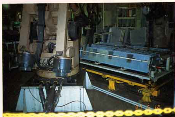
金子農機利用機器人進行乾燥機點焊工作
