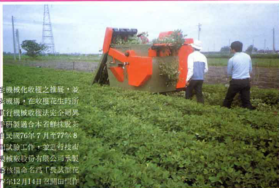
圖2：收穫機排株鏈組及田間作業情形
