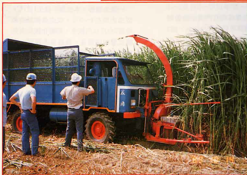
收穫機切割後的殘梗很整齊，較少發生碎裂現象。
