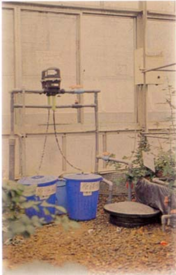
圖13. 稀釋定比器可調整養液濃度，並可直接灌注於栽培介質中。
