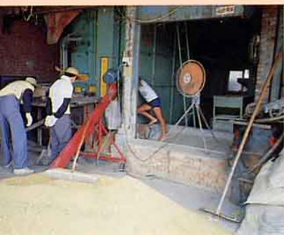
散裝稻穀利用電動螺旋輸送管送入個人乾燥機
