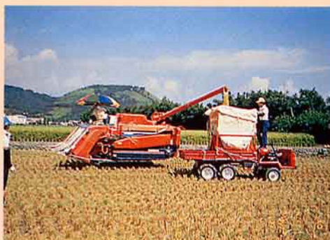
散裝水稻田間裝載—農用搬運車及側邊卸料大穀袋
