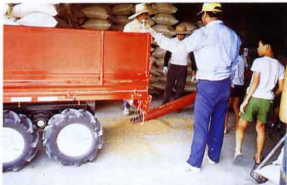
散裝式卸料可利用螺旋輸送管輔助送料入乾燥機
