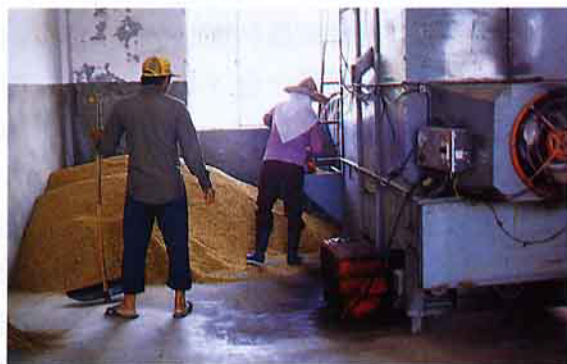
散裝式卸料與一般乾燥機入料口不能配合
