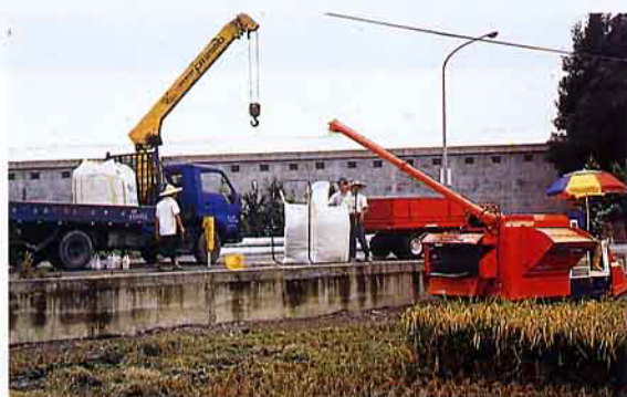
散裝式收穫機卸載大谷包並由吊桿貨車載運
