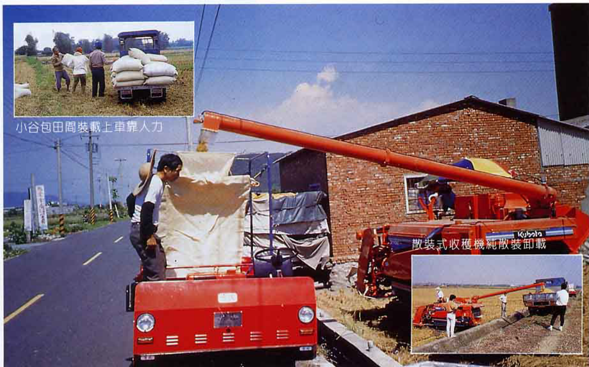
散裝式收穫機卸載大谷包並由農用搬運車載運
