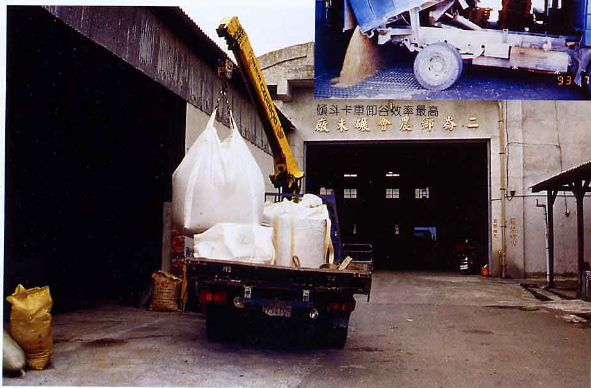
吊桿貨車吊載大谷包準備卸料
