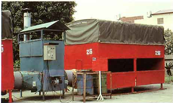
拖車式落花生乾燥機可以加裝輪子，能用拖車將乾燥箱自採收田裝滿落花生後，拖到乾燥中心連接燃燒母機來進行乾燥
