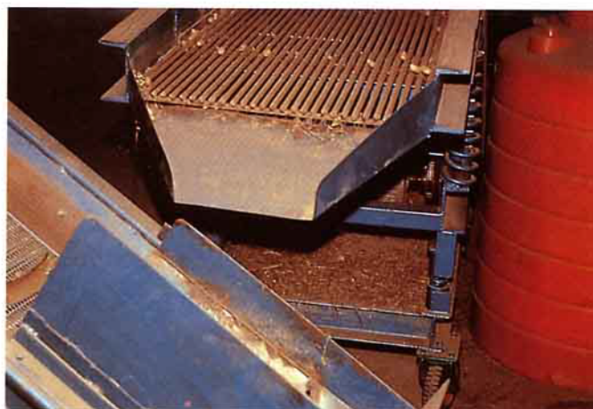
機械乾燥周邊設備：自動振落砂土裝置篩除落花生砂土
