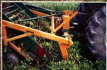
(2) 落花生植株由右深入土中的刈刀挖起，經由鏈條帶、振動、上送而掉落地面成行排列
