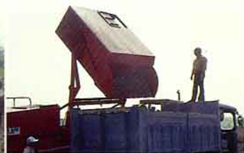
(2) 收穫後莢果貯存筒傾卸落花生至貨車上運送至農家乾燥
