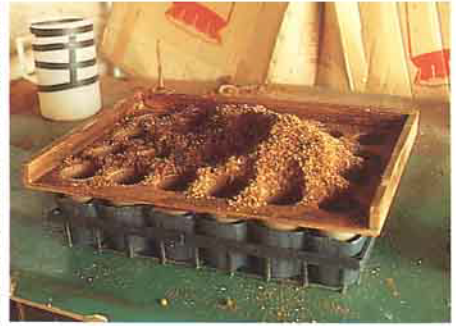
自行設計簡易的人工介質填裝盤，節省人工及提高效率
