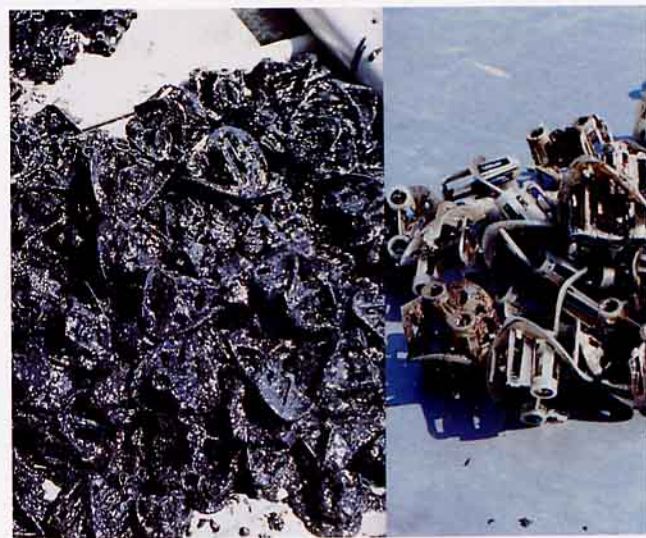
圖 2. 懸浮濾料生物膜過度生長之結晶情形
