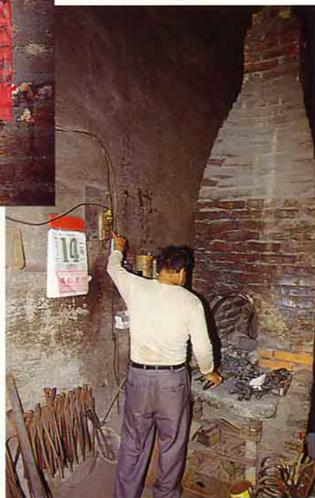
鎚打鐵塊 植入爐內 加熱
