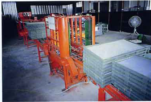
圖3 台南區農業改良場研發的自動化芽菜生產設備之一
