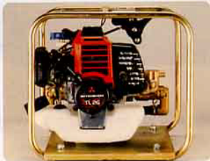
YC-26手提式引擎噴霧機 常用壓力30kg/cm 2 ，噴霧量每分鐘8ℓ，適合藥劑噴灑、清洗、消毒、洗車、試壓專用機
