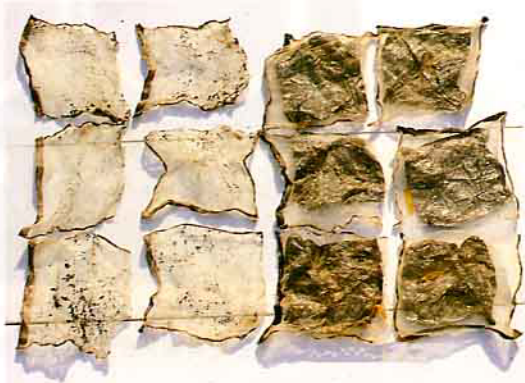
生物分解膜（左，右邊為傳統PE膜）經42天堆肥化處理後分解率達82.9%
