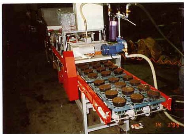
圖7 花卉軟盆自動介質混拌上盆機上盆後情形
