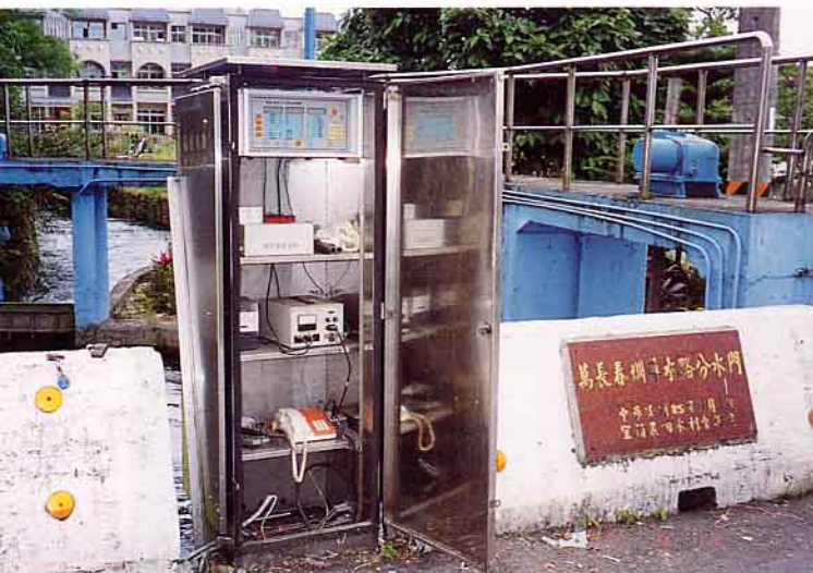
宜蘭農田水利會萬長春圳水位水量自動測報系統
