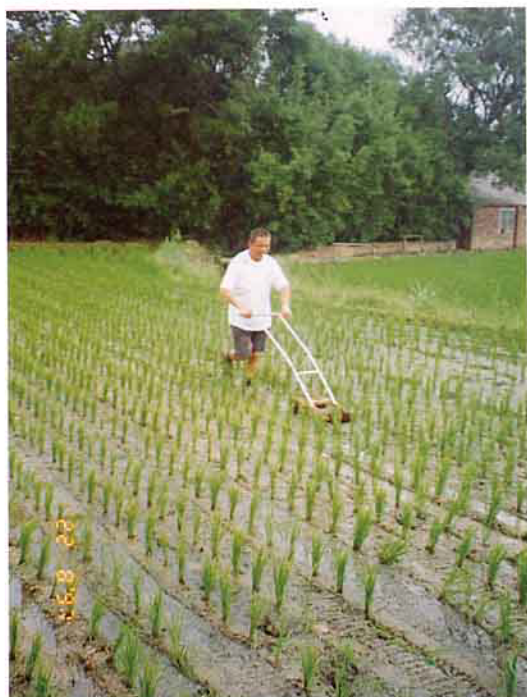
圖3 單行手推式中耕除草器作業情形
