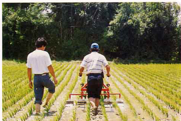
圖5 水稻中耕除草機田間作業情形
