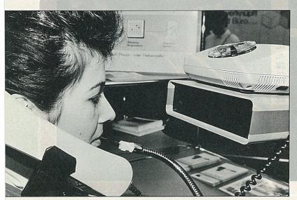
在社會對殘障者的照顧很週到,常提供特殊的服務,給予他們方便。西德工商業者亦不落人後,除預留工作機會給殘障者,設置具有特別設備的場所給予他們職業訓練外,更為殘障者設計新額實用的器材。圖中這套利用吸氣與吹氣的電話撥號系統,就是西德工業界專為運動神經受損者所設計的。電話號碼盤上同樣有 0~9十個數字,從"吹口"(mouthpiece)吹氣就可移動轉盤至下一個數字,要打的電話號碼可由吸氣來設定,所有打電話的功能全由"吹口"來控制。
