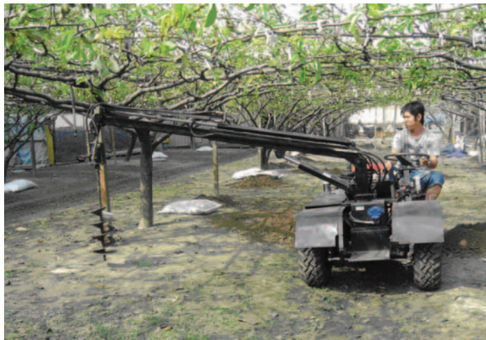
乘坐式油壓鑽孔機之主桿可迴旋及伸縮，引導鑽頭到車體前方可到達之處鑽孔，作業之靈活度高
