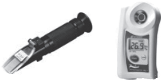
傳統使用手持式或數位式屈折計測定糖度 (摘自ATAGO公司)
