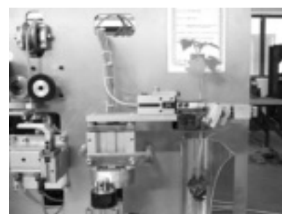
穗木自動夾持切斷定位機構
