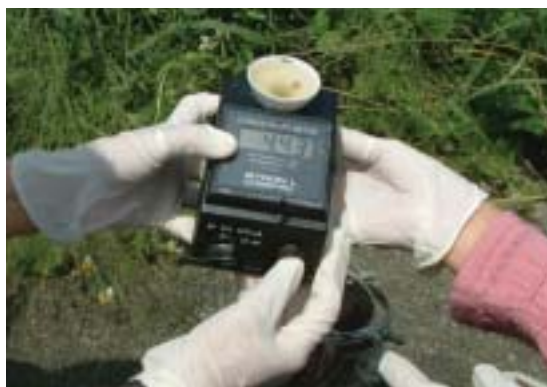
灌溉水質監測現場導電值量測
