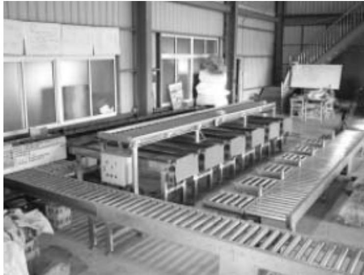
輸送機、計量機（150公斤型）及空箱供箱機組；計量系統採用電子式，可輸出日期、農友代號、果品類別、等級及重量等，利於產銷班作帳管理，配合作業人力5人，作業最大能力每小時3,600個以上，作業效率最高提升4.8-7.2倍。■
