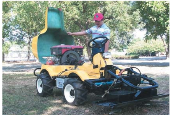
後置引擎設計及機身採美觀耐用的玻璃纖維開模製造
