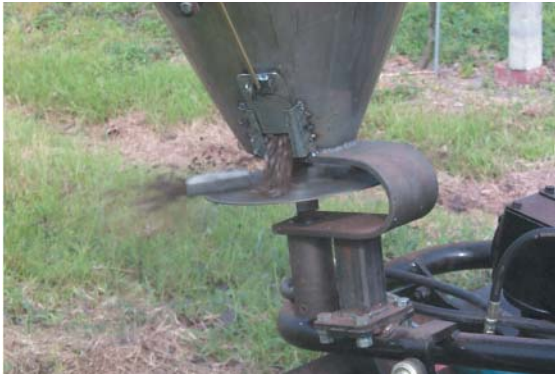
施肥裝置採離心式撒佈作業，圓盤轉速及出肥量可調整
