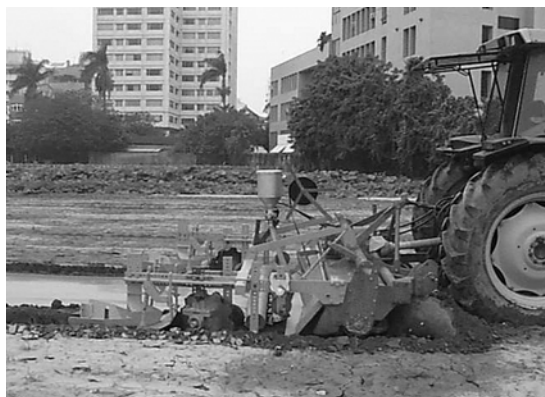
RM240型築畦、塑膠布鋪設機一次可完成開溝、築畦、塑膠布鋪設，也可同時完成地下害蟲藥劑及噴灌水帶的鋪放作業
