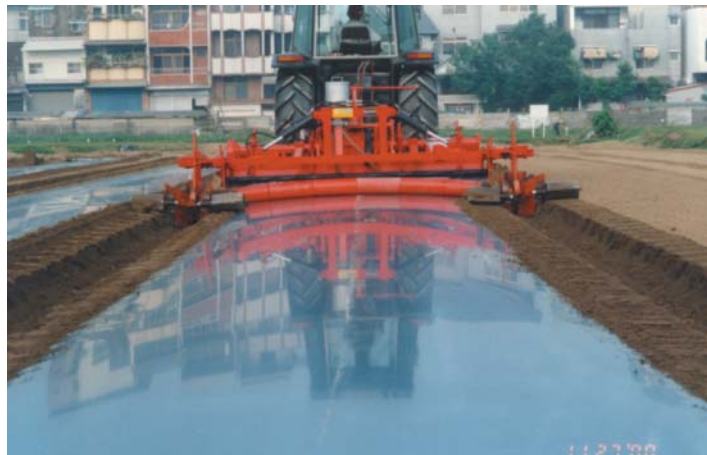
RM270型適於西瓜栽培畦鋪設，具油壓舉昇裝置，確保行車駕駛安全
