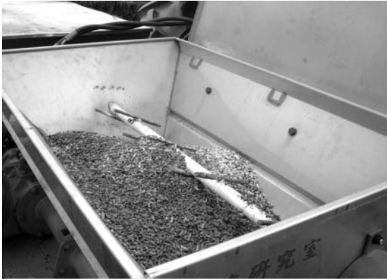
施肥箱裝填有機質肥料施用與土壤攪拌後達到立體分布於畦床上
