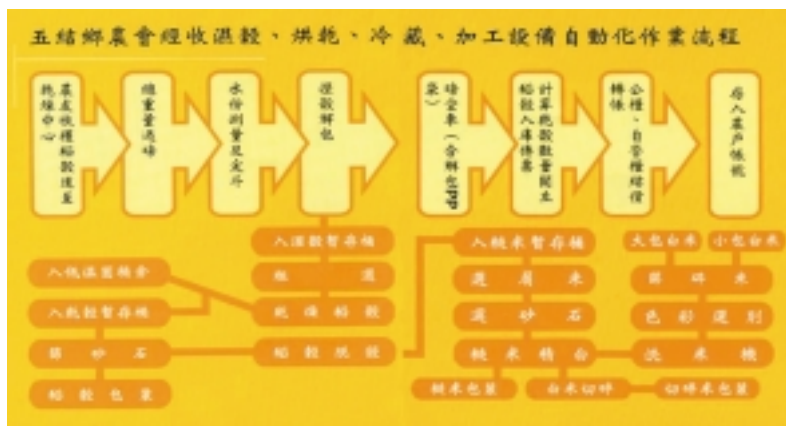
五結鄉農會經收濕穀、烘乾、冷藏加工設備自動化流程(五結鄉農會提供)
