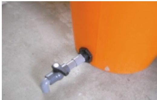
圖四 醱酵桶下方加活動栓塞，方便流出之收集
